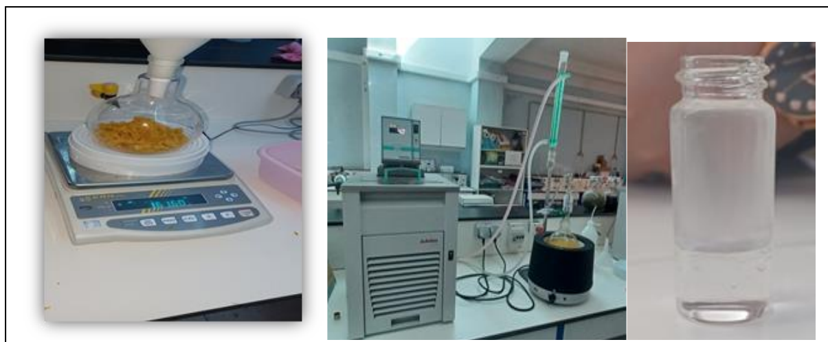
Figure 14 : Les différentes étapes d'hydrodistillation
